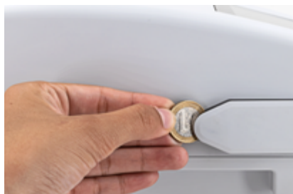
Fig. 1: Retirar la tapa de las interfaces
