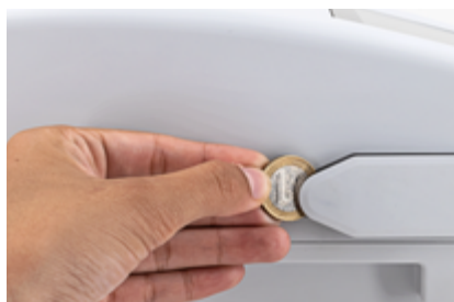
Fig. 1 : Enlever le couvercle de protection des interfaces
