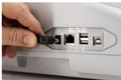
Fig. 2: Conexión de la alimentación eléctrica
